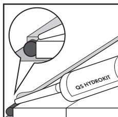
**1** L'étanchéité des joints de dilatation périphériques combine une mousse PE compressible d'un diamètre de 8 à 10 mm et l'HydroKit Quick-Step flexible et résistant à l'eau. Poussez la mousse PE dans les joints de dilatation et appliquez l'HydroKit Quick-Step flexible en l'inclinant légèrement vers le sol Quick-Step.
