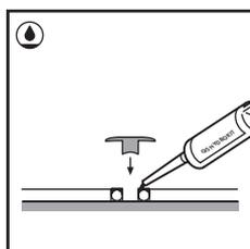
**3** Fixez le profilé de base Incizo sur le sol de base à l'aide de la colle One4all Quick-Step et/ou de vis. Appliquez l'HydroKit flexible sur la mousse PE flexible qui se trouve dans le joint de dilatation.
