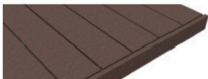
Pour habiller la lambourde dans le sens longitudinal (lames transversales), fixer la jupe sur la lambourde en laissant un joint de 5 mm entre les lames et la jupe.
