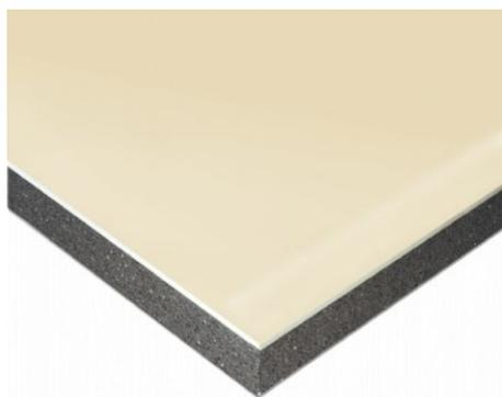
Complexe de doublage constitué d'un panneau isolant en polystyrène expansé (PSE) graphité, associé à une plaque de plâtre Placo®. Parement plaque de 13 mm permettant utilisation en ERP.
