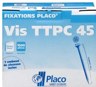
Vis autoperceuse à tête trompette et pointe clou pour fixation de plaques de plâtre Placo® sur ossature Placostil® ou sur ossature bois. La longueur de la vis est de 45 mm.
